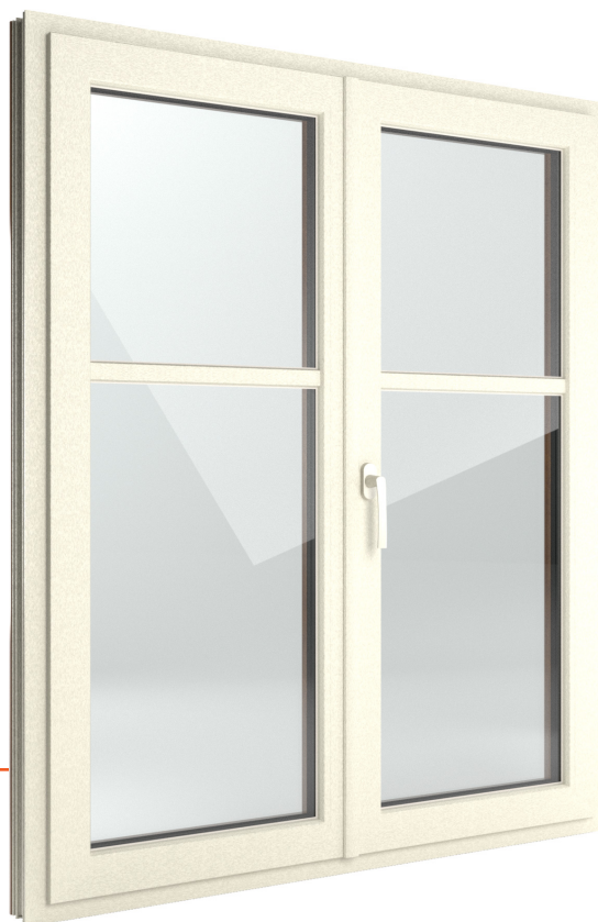
Illustration : exécution en deux vantaux avec parclose et petits bois rapportés en design classique, extérieur aluminium Castagno L13 et intérieur PVC blanc perlé veiné 07
